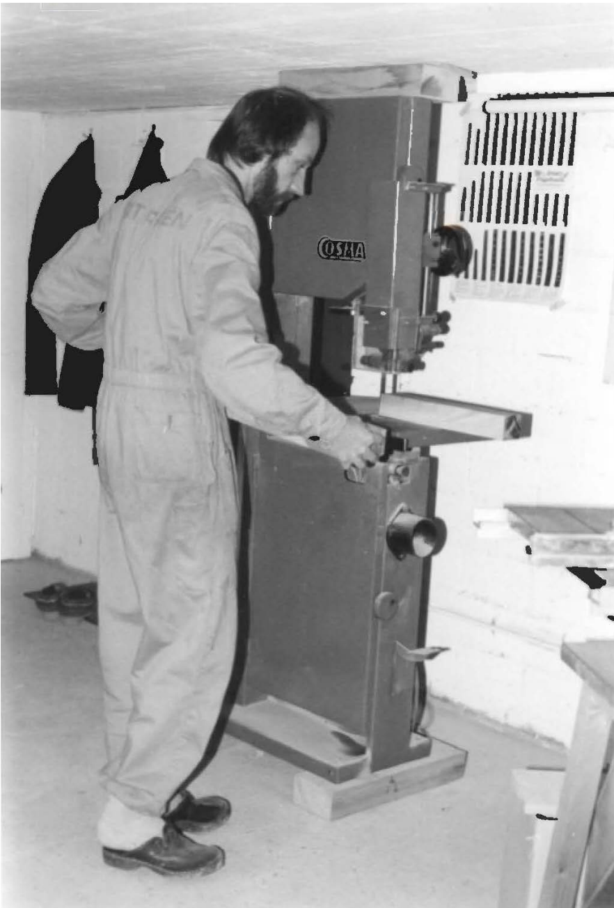
Mit der Bandsäge werden die Bretter zuerst in Kanteln von 4 - 6 cm Dicke zugeschnitten.
